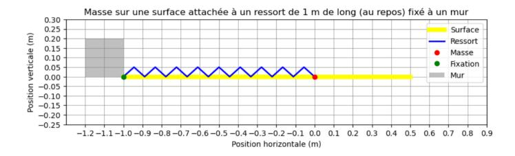
La masse est tirée de sa position d'équilibre et déplacée de 40 cm avant d'être relâchée sans vitesse initiale.
